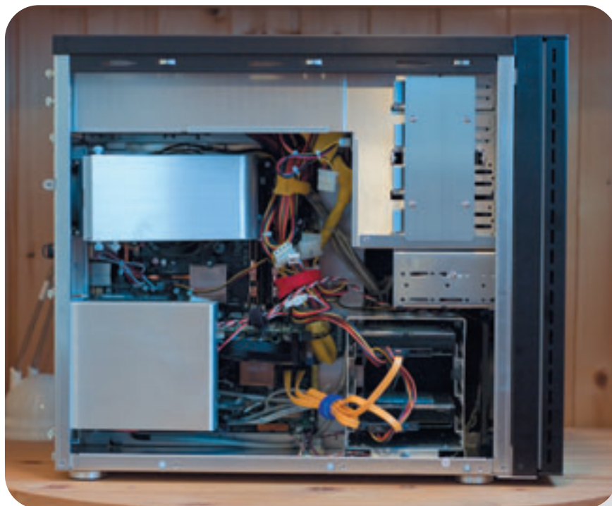
Система в сборе. Слева внизу — та самая запатентованная конструкция, отводящая горячий воздух от видеокарты. Слева сверху — регулируемая направляющая, которая заметно улучшает охлаждение процессора и памяти. И все, абсолютно все в корпусе Lian Li, сделано из алюминия.
