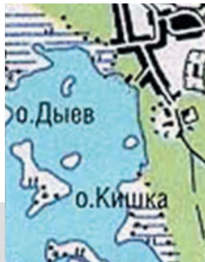
Рис. 3. Действие эффекта Гиббса на примере фрагмента карты, сохраненной в формате JPEG с большой степенью сжатия.
