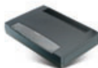
P-660HT Домашний интернет-центр с модемом ADSL2+ для трех компьютеров и ТВ-приставки
