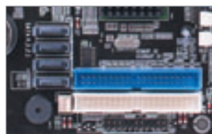
Два IDE-разъема на материнской плате встретишь уже не всегда. Зато SATA производители стараются предоставить в достаточном количестве.
