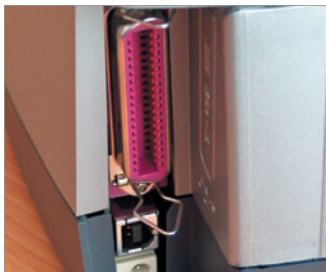
Еще недавно единственный способ подключения принтера — разъем Centronics — теперь почти полностью вытеснен USB. А вот если вы встретите такой разъем на старом компьютере, то это не принтерный, а SCSI.
