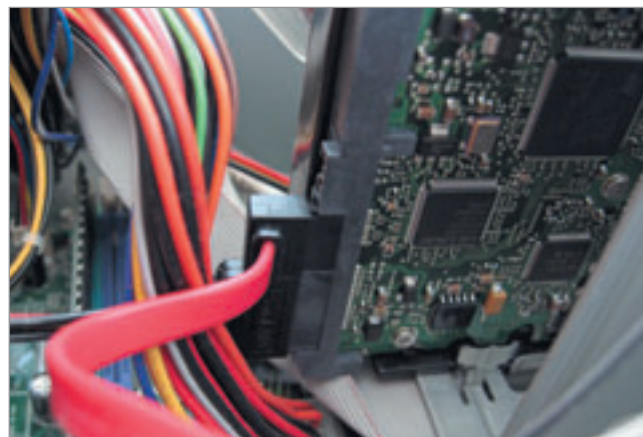
Кабели SATA намного тоньше, чем IDE, но разъемы требуют бережного обращения: сломать их намного проще.
