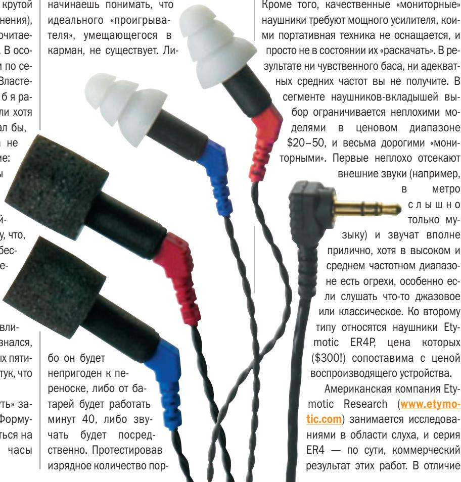
от серии ER4S, серия Р рассчитана именно на работу с портативной техникой — чрезвычайно небольшие и узкие телефоны располагаются достаточно глубоко в ушном канале, снижая внешний шум практически до нуля. Также разработчики специально уменьшили внутреннее сопротивление до 24 Ом и улучшили воспроизведение басов. Кроме того, наушники могут похвастаться очень качественным, «неломающимся» проводом — производитель не побоялся дать на них двухлетнюю гарантию.
