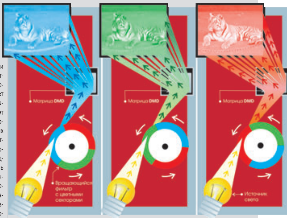
Оптическая схема проектора DLP с одним DMD.
