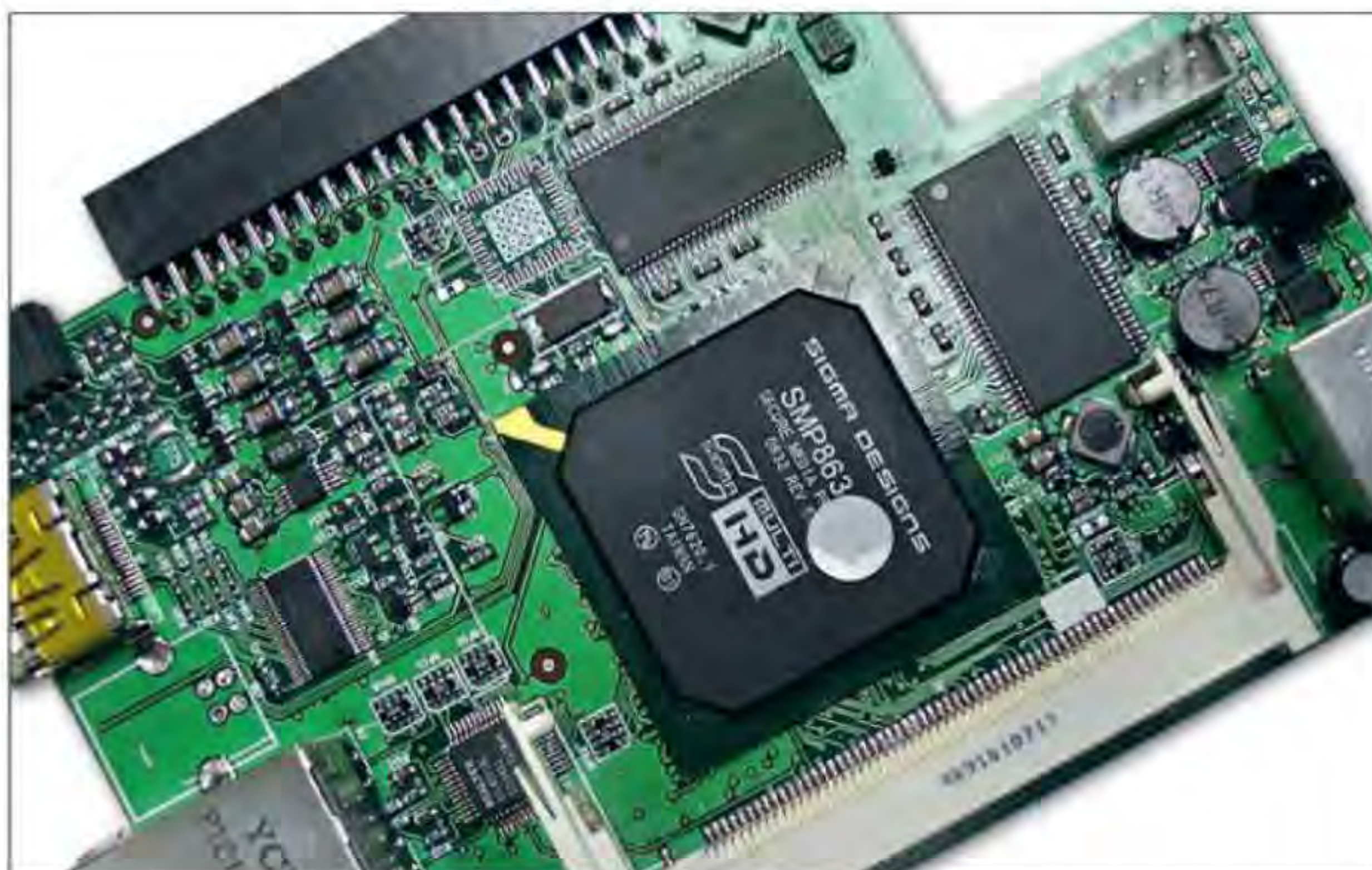
Плата с одним из первых чипсетов Sigma Designs SMB 863x из устройства с говорящим названием Popcorn Hour, модель A-110. Кроме чипа и буферной памяти видны контроллеры USB и LAN
