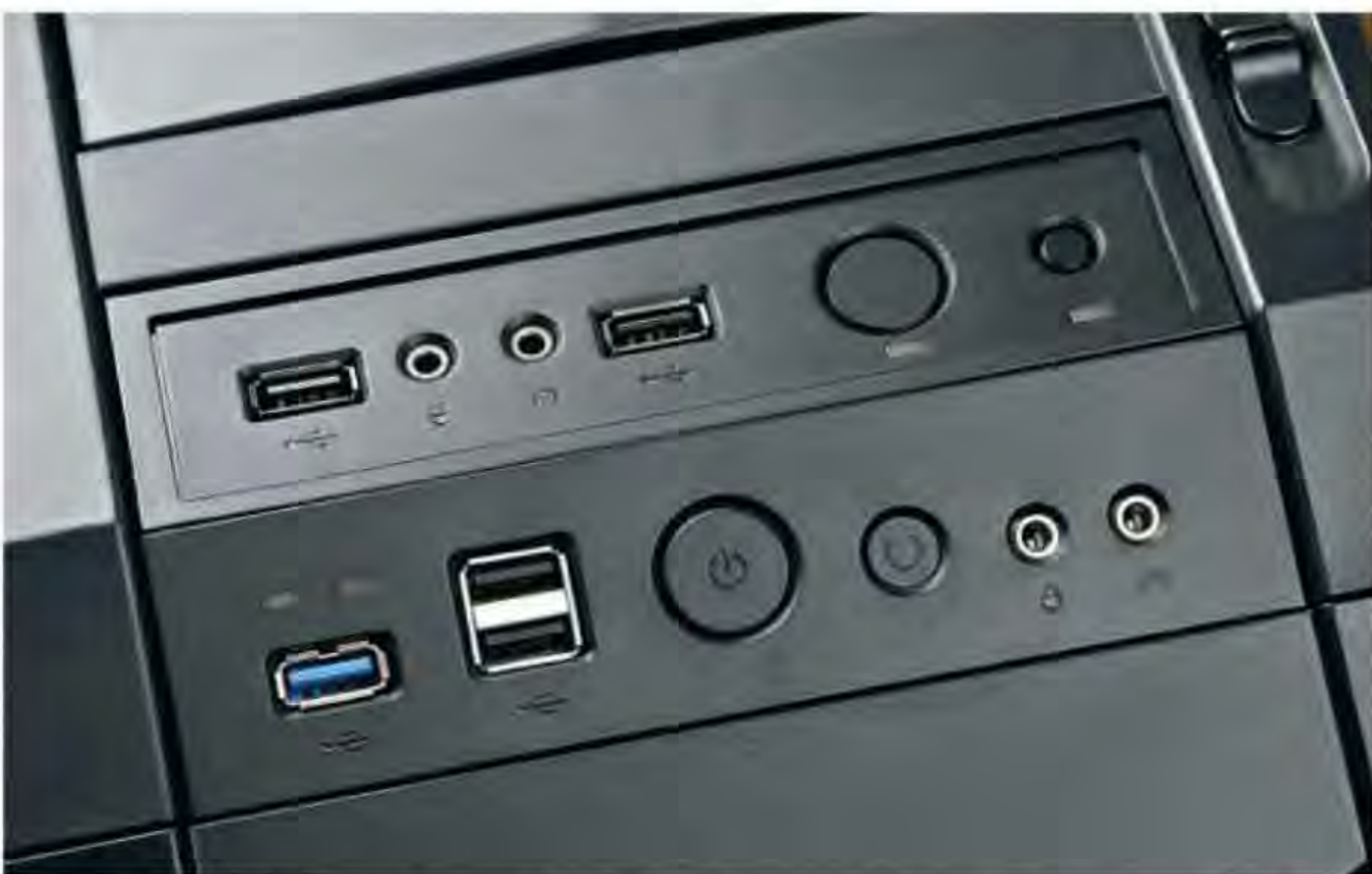
Поначалу двойной комплект органов управления повергает в некоторое недоумение, но, когда узнаешь о том, что в одном корпусе помещаются два компьютера, все встает на свои места
