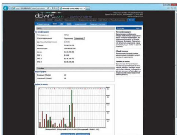
Система автоматически считывает прокачанный через роутер трафик, а также строит графики загрузки сетей
