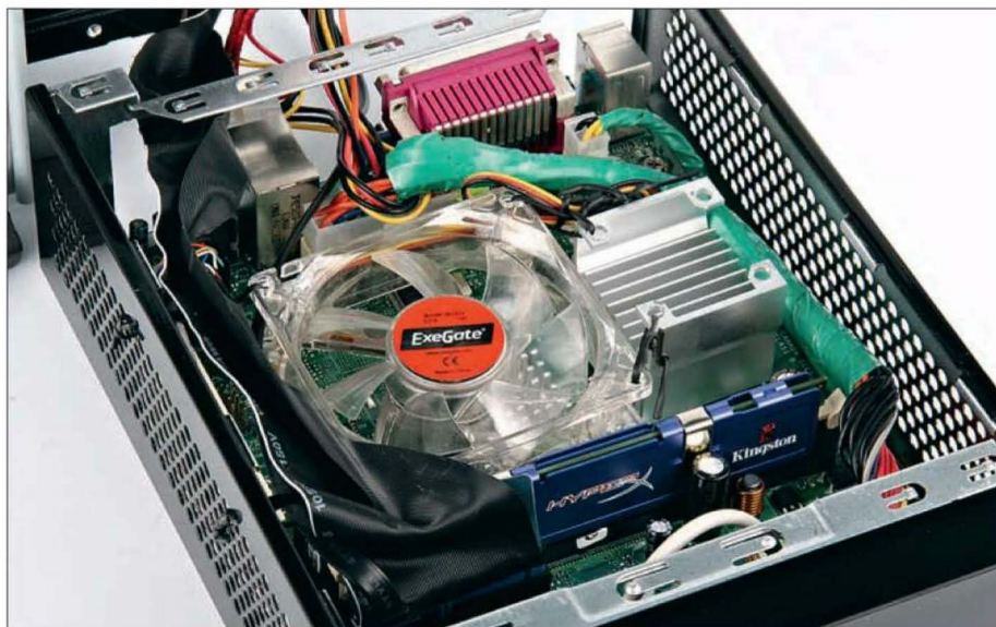
80-миллиметровый вентилятор прекрасно уместился в тесном кейсе, обдувая и северный мост, и радиатор процессора платы Intel D201GLY2A. Вертушка висит на растяжках
