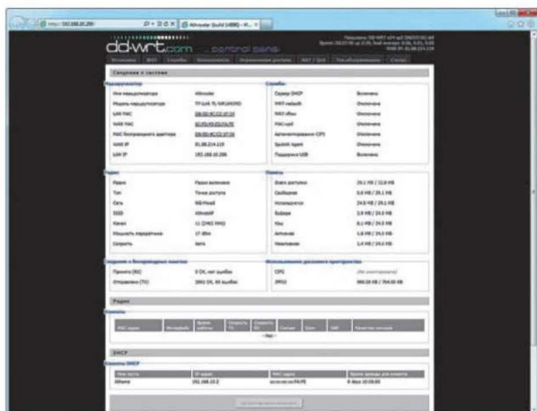
При заходе в веб-интерфейс DD-WRT сразу же показывает краткую сводку о состоянии системы
