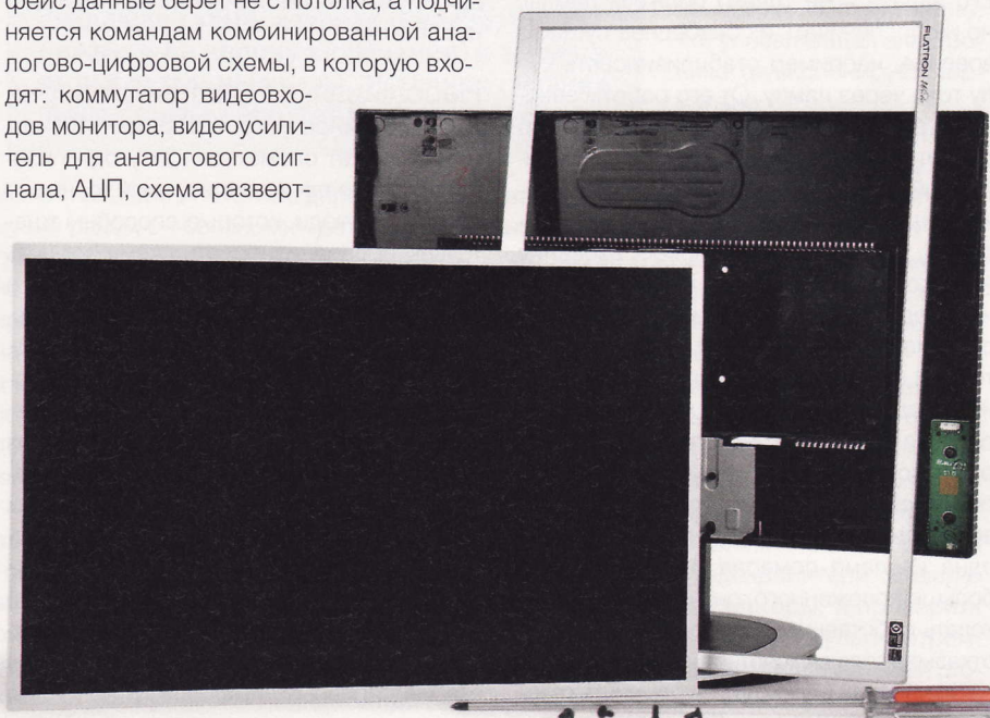
Три составные части практически любого монитора: корпус, матрица в сборе с БП и управляющей электроникой, декоративное обрамление
