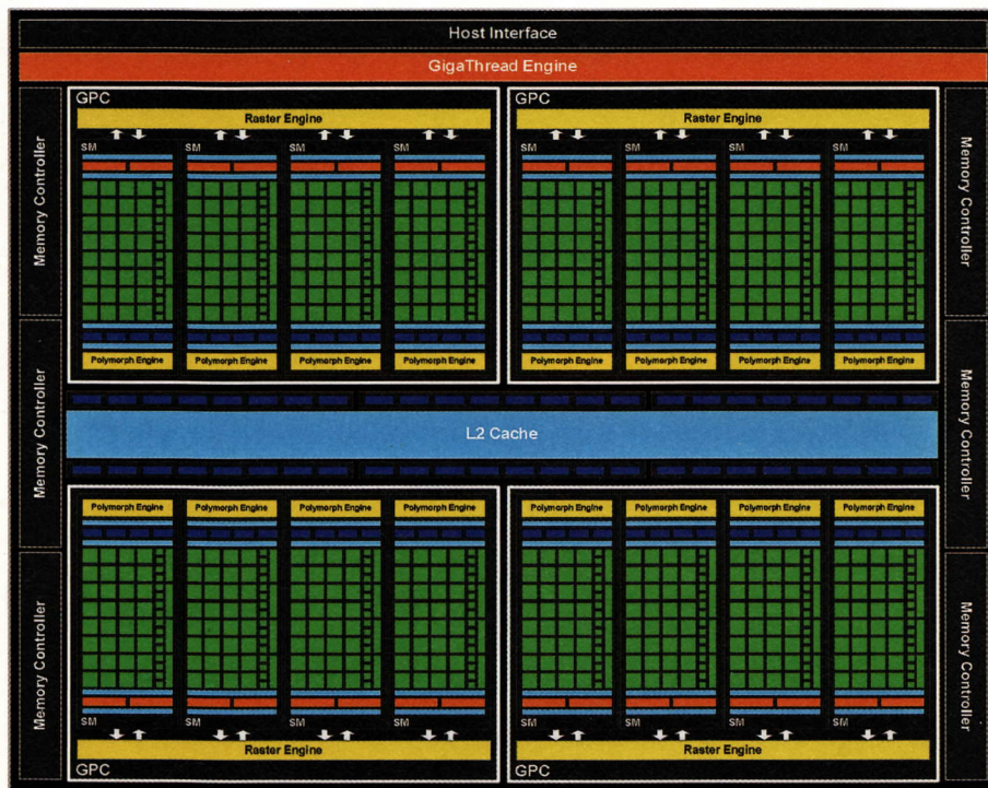
Структурная схема «полного» графического процессора GF100 с шестнадцатью SM
