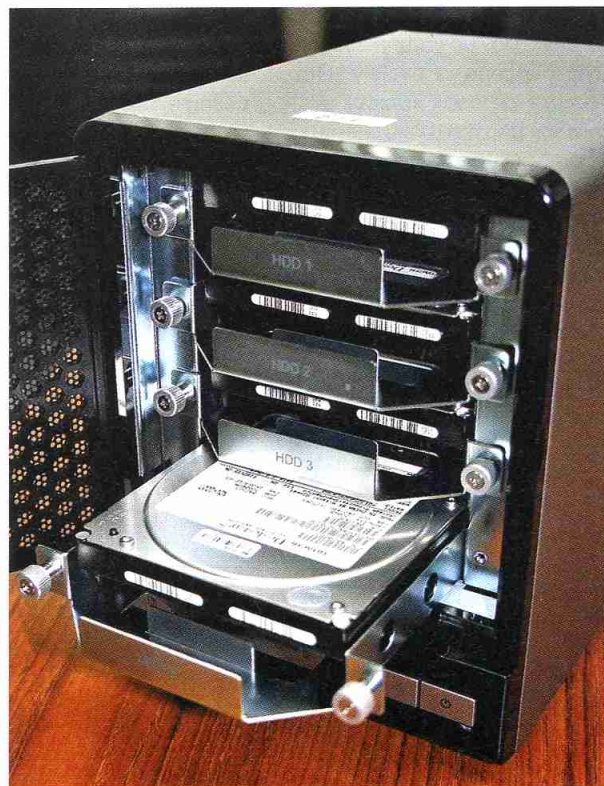
Домашнее использование трех- или четырехдискового NAS на базе RAID 5-массива, «питающий» файлами все ваши устройства
