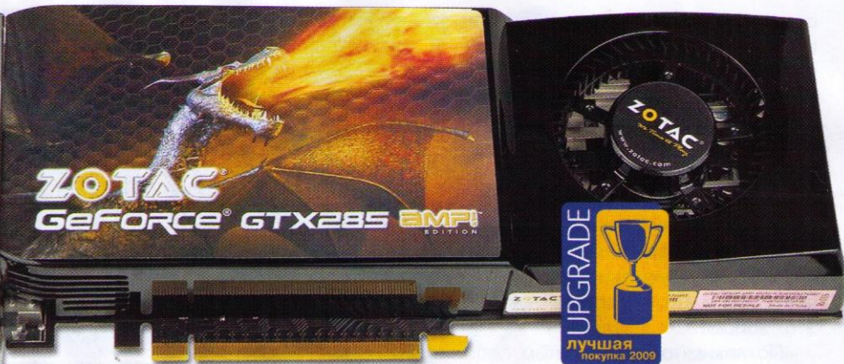
ZOTAC GEFORCE GTX285 AMP! Zotac расхрабрилась и выпустила сразу разогнанную версию 285-й: частоты чипа и памяти составляют 702 / 1512 МГц и 1296 (2592) МГц
