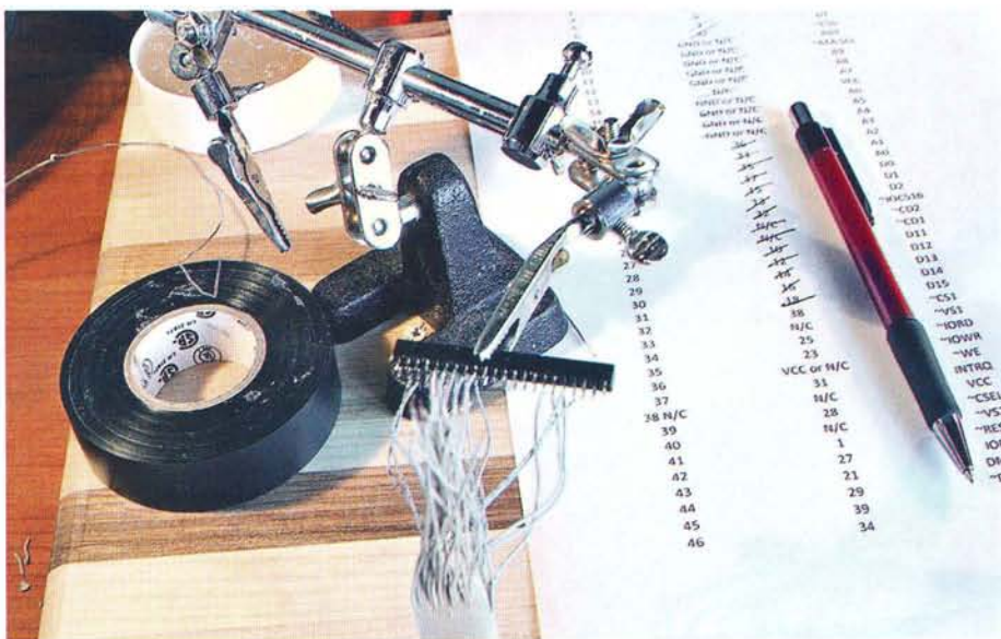
Вот так приходилось «лечить» поврежденный IDE-шлейф, если под рукой не было нового
