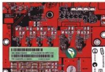
Неодинаковые аппетиты карт линейки 48xx отразились и на системе питания
