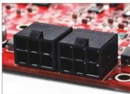
Отрадно, что ATI не стала устанавливать на карту HD 4870 восьмиконтактные разъемы
