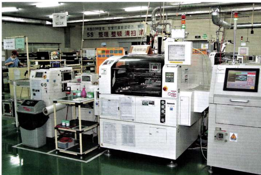
Вот так выглядят механизмы для установки отдельных компонентов на печатные платы
