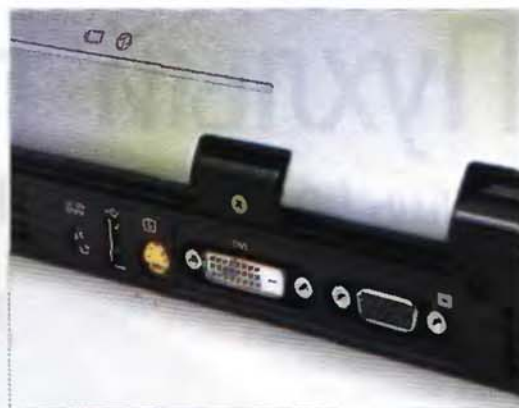
Наличие как аналогового (D-Sub), так и цифрового (DVI-I) интерфейса – редкость даже для дорогих ноутбуков.
