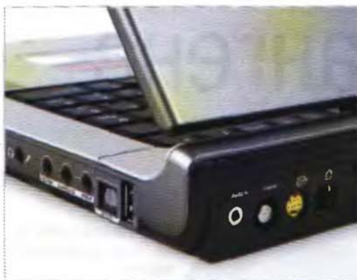
Правая панель: композитные аудиовходы и аудиовыходы, разъем S/P-DIF (оптический) и порт USB 2.0
