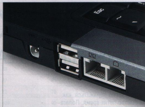
Левая панель интерфейсов: разъем питания, 2 x USB, сетевой порт и модем
