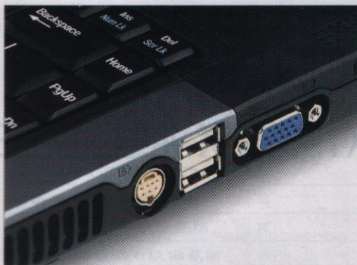
Правая панель интерфейсов: D-Sub, 2 x USB и разъем для внешней клавиатуры
