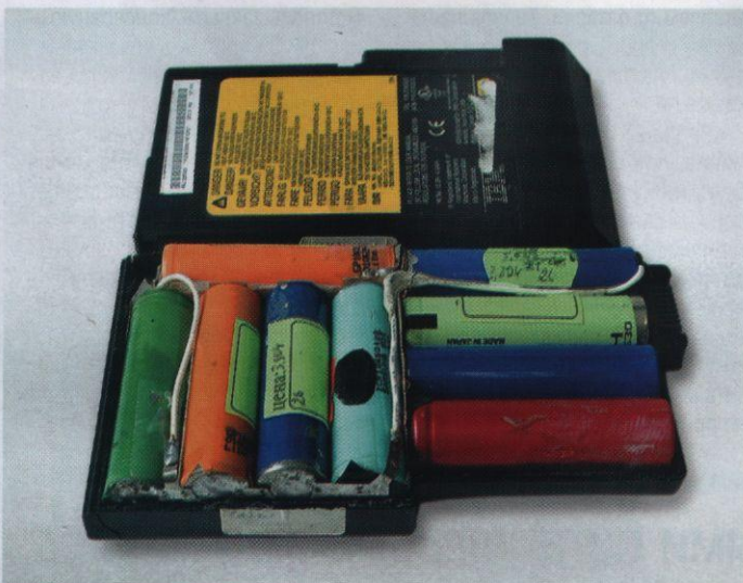
Неправильно восстановленная батарея
