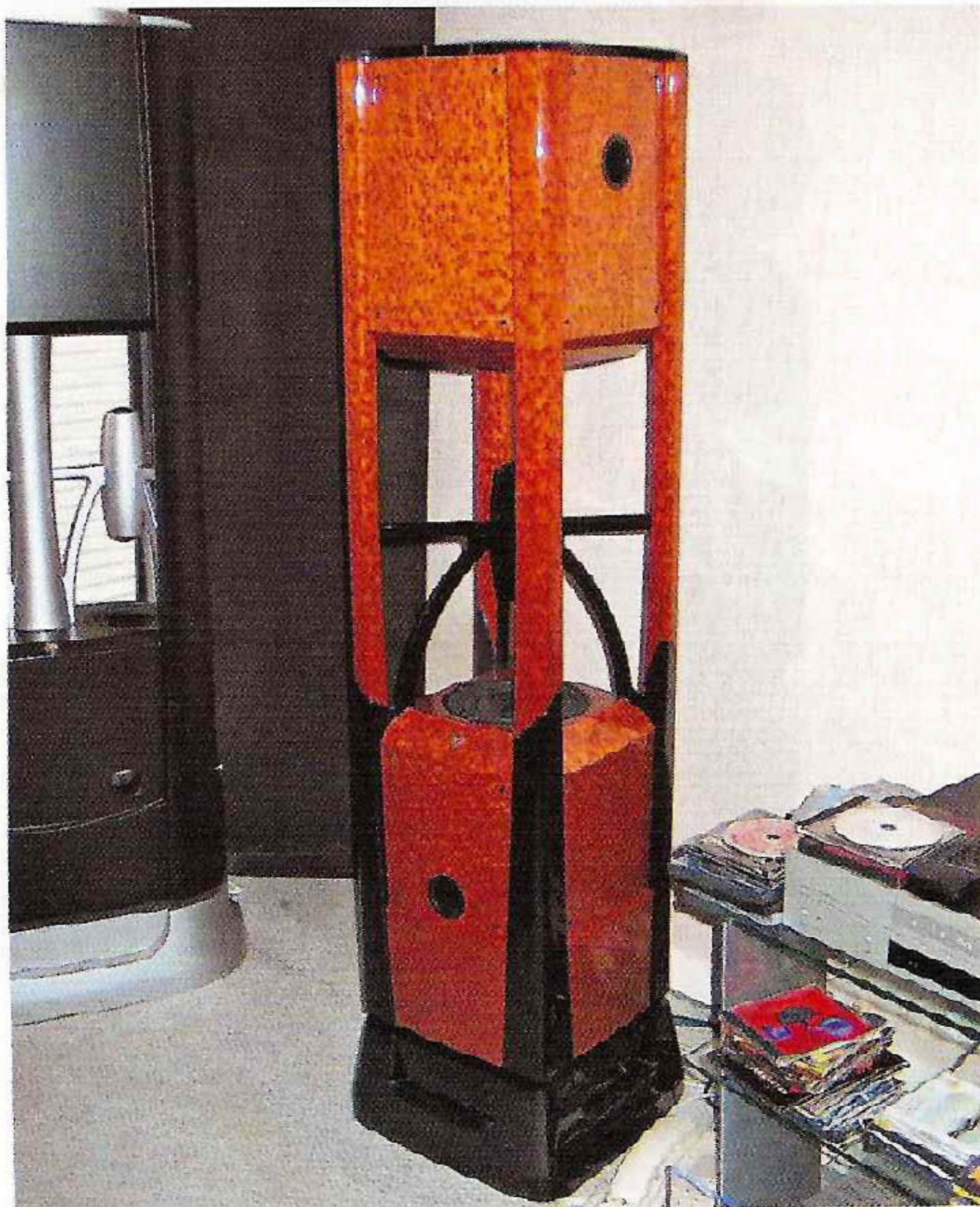
В центре конструкции – твиттеры. В верхнем и нижнем корпусах – СЧ-НЧ-драйверы.
