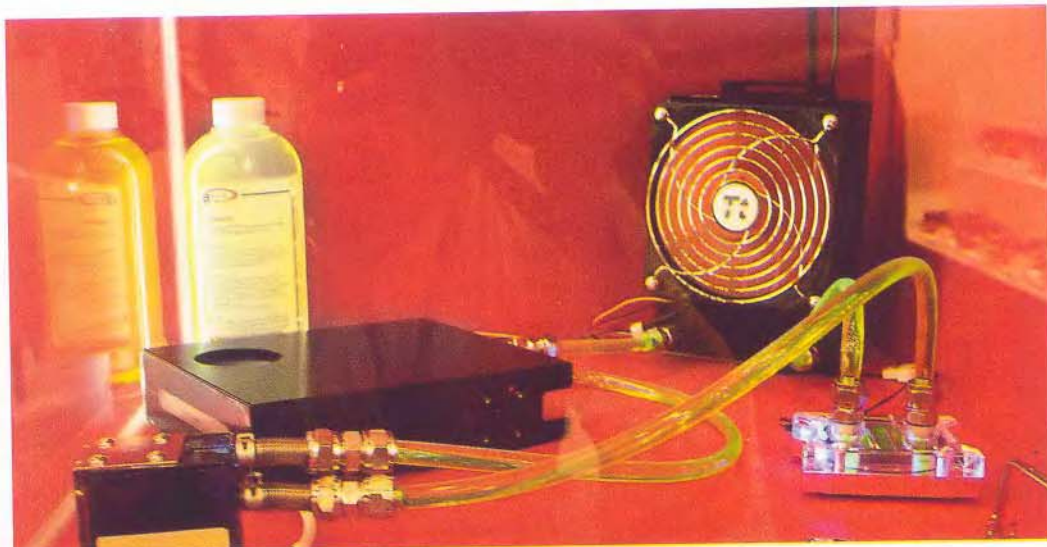
Вторая версия системы Thermaltake BigWater. Помпа стала поменьше, форма изменилась, а ватерблок тот же.
