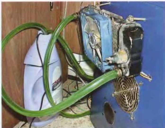
Радиатор – одна из самых больших частей системы. К счастью, изготавливать его необязательно – можно взять радиатор от автомобильной "печки".
