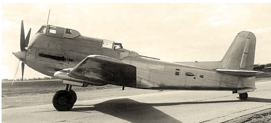
Главная особенность компоновки штурмовика Ил-20 заключалась в размещении кабины лётчика не за мотором, а над ним. Тяжёлый бронированный штурмовик Ил-20 — попытка найти новые решения, также оказавшаяся неудачной
