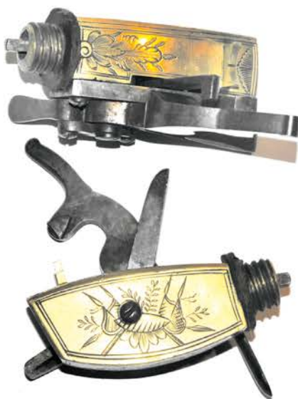
Редуктор. На фото хорошо видны внешние элементы, которые своим видом напоминают части традиционного кремнёвого замка, в частности — курок
