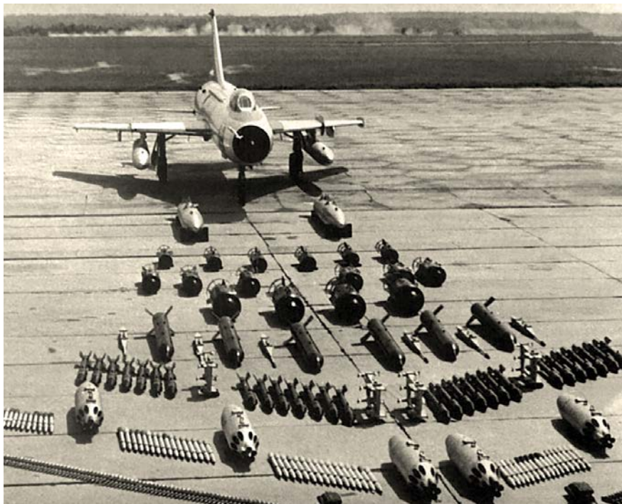
Вооружение Су-7Б и последующих модификаций (на снимке — БМК) вполне подходило для штурмовки, но по лётным свойствам это типичный истребитель-бомбардировщик
