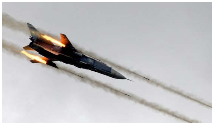
Самолёт Су-24 — фронтовой бомбардировщик с вооружением штурмовика
