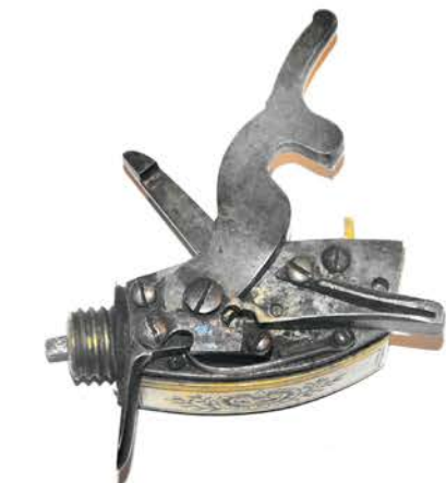
Редуктор. На фото хорошо видны внешние элементы, которые своим видом напоминают части традиционного кремнёвого замка, в частности — курок
