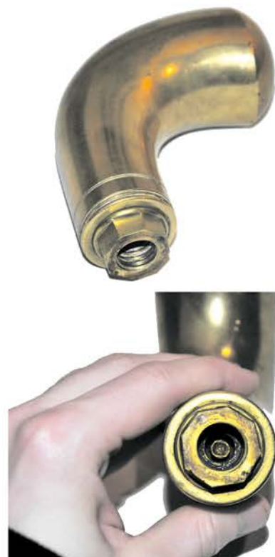
Резервуар для сжатого воздуха выполнен в виде полую рукоятки, на которой есть выступ с резьбой для крепления к редуктору и клапаном для совершения выстрела и накачки воздуха в ёмкость
