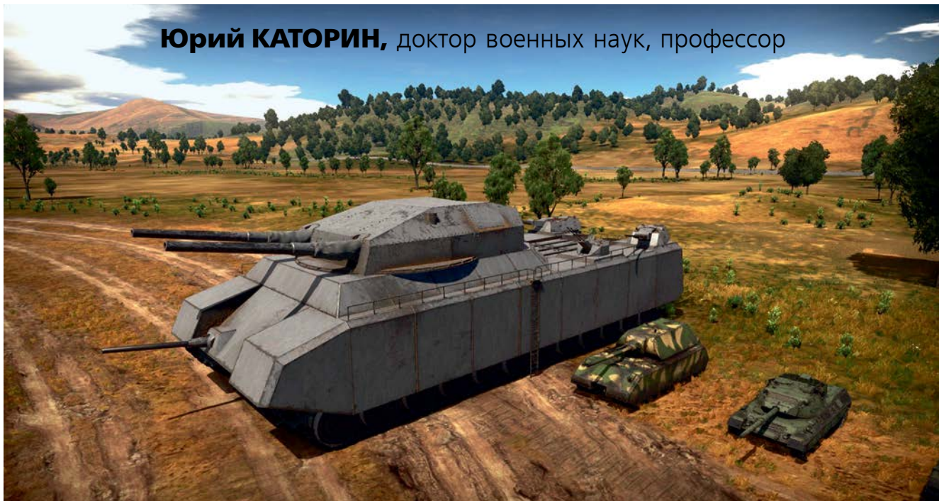
Эскизный проект сверхтяжёлого танка Гротте ТГ-5 весом в 1000 т
