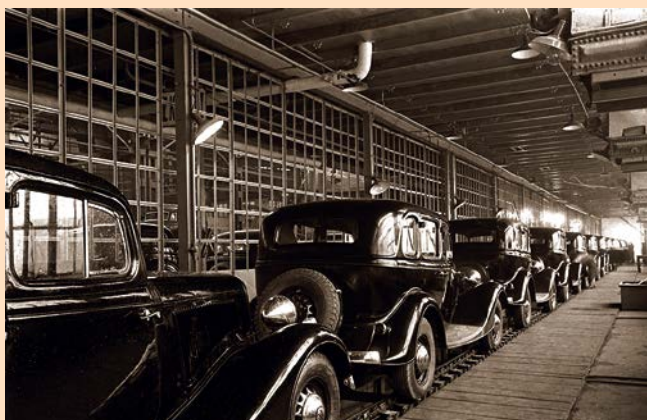
Главный конвейер Горьковского автозавода (ГАЗ). Хорошо видна его фордовская организация, а также фирменные кановские стеклянные перегородки и большие окна в потолке, свет от которых хорошо виден на фото. 1939 год
