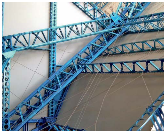
Силовой каркас дирижабля Pathfinder-1
