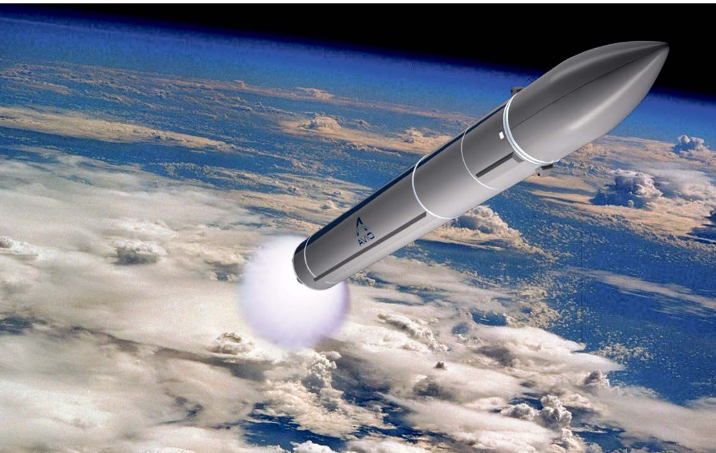
Перспективная двухступенчатая метановая сверхлёгкая ракета-носитель (Avio)
