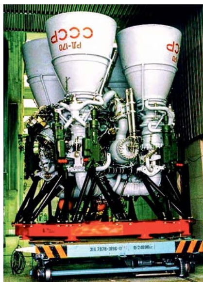
Советский РД-170 — один из предшественников новой разработки, взятый за основу при изобретении современного «царь-двигателя»
