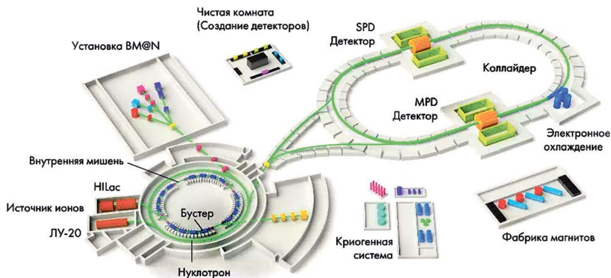
Схема ускорительного комплекса NICA. © Nuclotron-based Ion Collider fAcility
