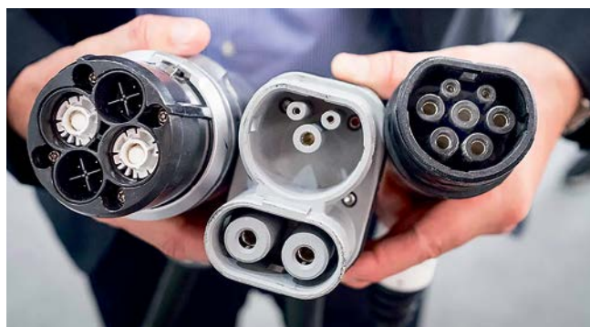
Разъёмы CHAdeMO, CCS Combo 2 и Type 2 для зарядки электромобилей
