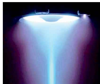
Успешно прошли и контрольные испытания российских плазменных двигателей КМ-75, предназначенных для спутников и обладающих самым высоким ускоряющим напряжением среди существующих аналогов
