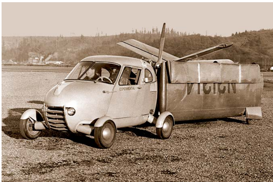
«Аэрокар» везёт за собой крылья, хвостовую часть и оперение
