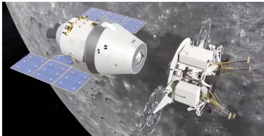
Пилотируемый корабль и лунный посадочный корабль на окололунной орбите (CASC)
