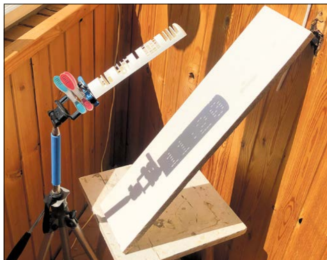
Устанавливаем солнечные часы на штатив с помощью бельевых прищепок. Разворачиваем их в нужном направлении для правильного отображения времени
