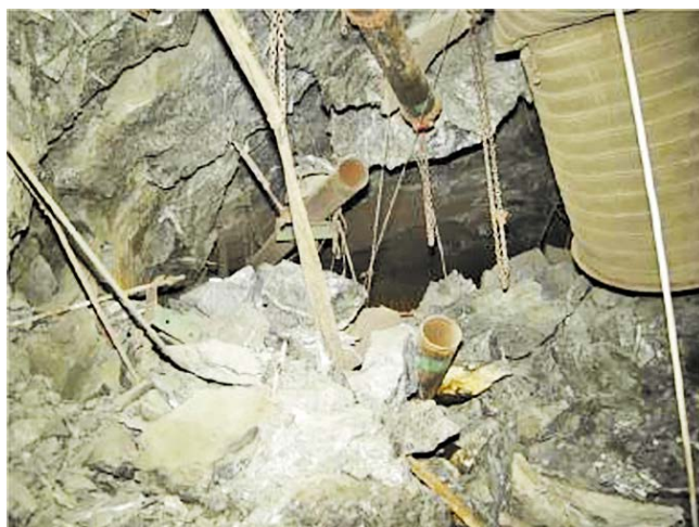
Рис. 7. Интенсивный выброс, вызванный сейсмическим событием в австралийской шахте.
