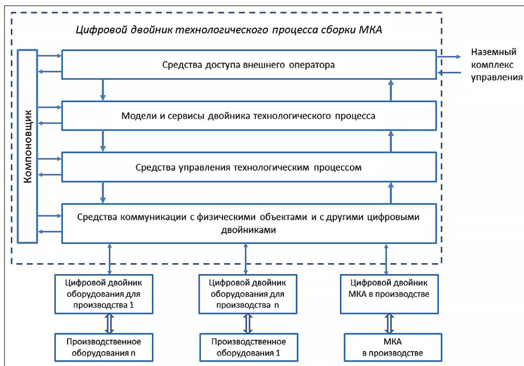
Рис. 6. Архитектура цифрового технологического двойника для организации автономного производства МКА на орбите
