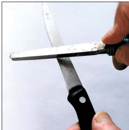
Рис. 8. Заточка ножа трёхгранной призмой
