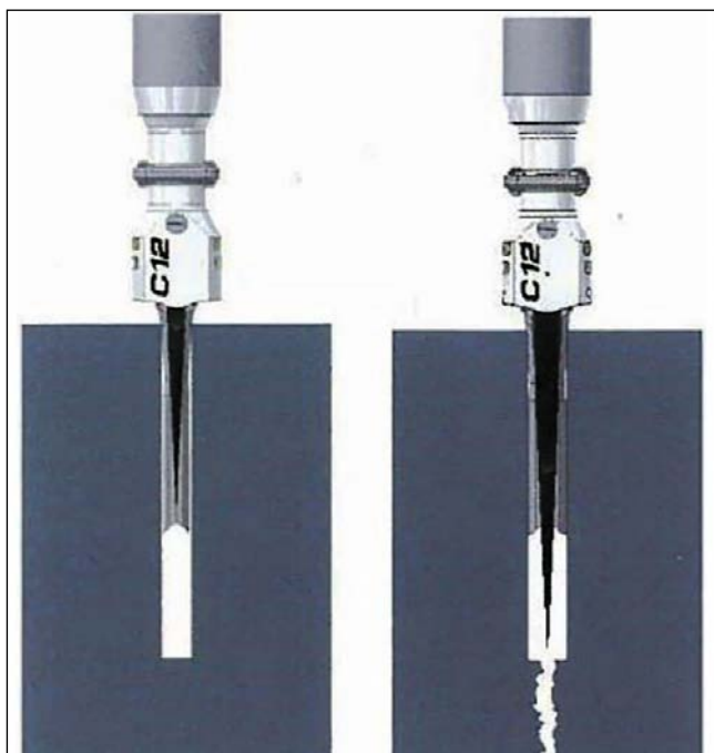
Рис. 14. Схема гидравлического расчленения горных пород. https://repository.up.ac.za/bitstream/handle/2263/70979/deGraaf_Preliminary_2018.pdf?...
