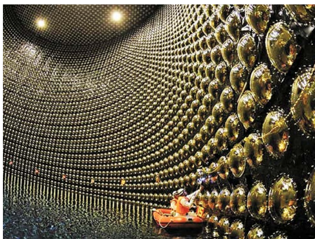
Рис. 12. Инженеры проверяют фотоумножители Супер-Камиоканде. https://physicstoday.scitation.org/doi/10.1063/PT.6.2.20181004a/full/
