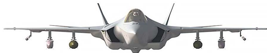
Такие габаритные АСП F-35 способен нести только на внутренних подкрыльевых пилонах
