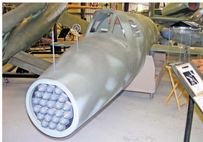
Мини-перехватчик Ва-349 «Natter» со снятым носовым обтекателем, видна ракетная батарея
