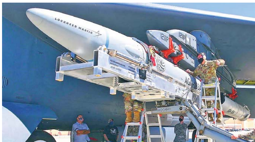
Персонал авиабазы Эдвардс проводит работы по подвеске опытной ракеты на пилон бомбардировщика Б-52, вторая ракета (белого цвета) это массогабаритный макет
