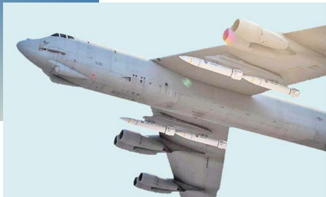
Бомбардировщик Б-52G способен нести на внешних узлах подвески до четырёх ракет AGM-183A ARRW
