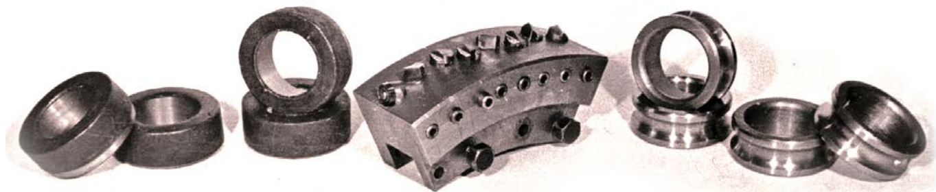
Рис. 2. Заготовки, сегмент протяжки и обработанные кольца
