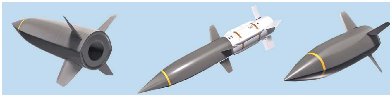
Гиперзвуковая КР AGM-182A HAWC, без стартового ускорителя, заправленная горючим весит 1100 кг. На этой ракете предостаточно места для ядерной БЧ, вероятные кандидаты — W-80 и W-84
