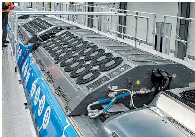
Топливные элементы iLint устанавливаются на крыше
