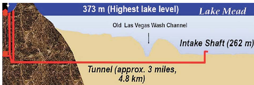
Рис. 9. Разрез по туннелю и водозаборному узлу № 3.
