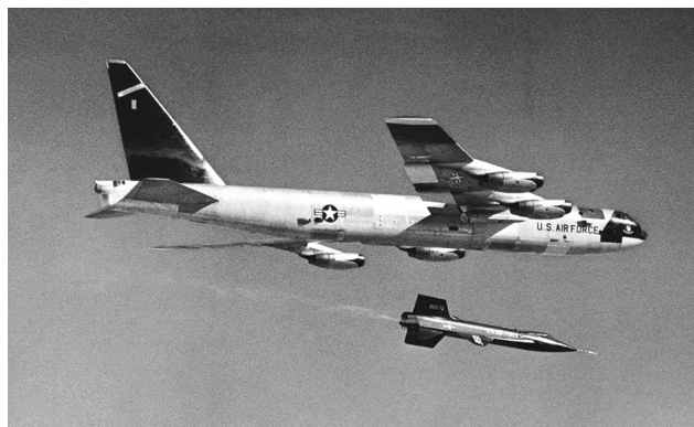
Рис. 29 X-15, третий образец, отрывается от своего самолёта-носителя B-52 во время одного из 65 полётов в рамках программы, достигая максимальной скорости 5,65 Маха и максимальной высоты 354 200 футов
