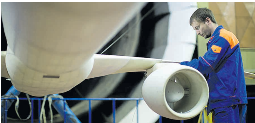
В ЦАГИ создали модель самолёта МС-21 с крылом из отечественных композиционных материалов
