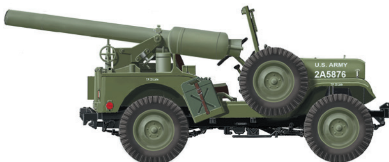
120-мм гладкоствольное безоткатное орудие M28
