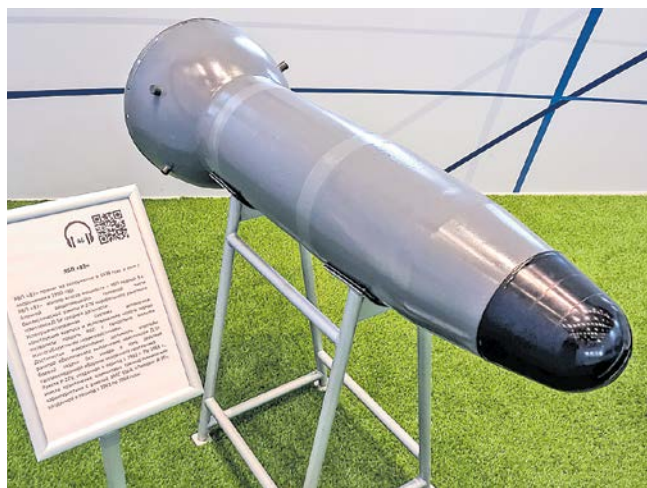
Советская ядерная головная часть 4Г10 баллистической ракеты подводных лодок Р-27, вес ГЧ — 650 кг, мощность — 700 кт
