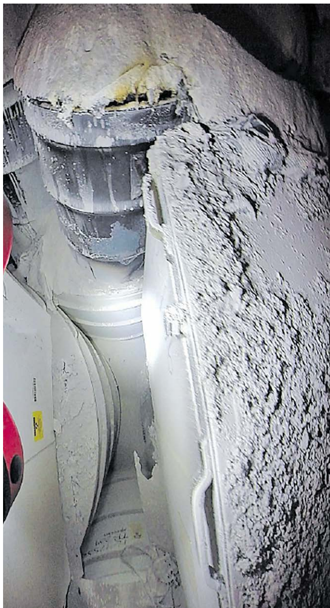
Рис. 6. Повреждённый барабан хранения отходов после утечки радиоактивных материалов 14 февраля 2014 года.
