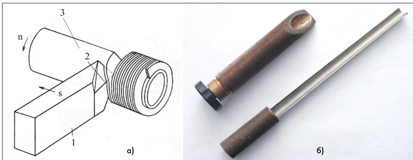
Рис. 3. Деформирующее резание: а) схема, б) виды обработанных поверхностей. 1 — резец, 2 — лезвие, 3 — трубка
