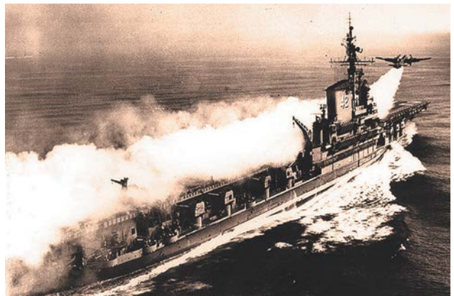
Взлёт бомбардировщика P2V-3C «Нептун» с помощью стартовых ускорителей с палубы авианосца CVB-42 «Теодор Рузвельт». Этот взлёт очень похож на цирковой номер, и всё ради того, чтобы стратегическое ядерное оружие появилось во флоте. Июль 1951 года
