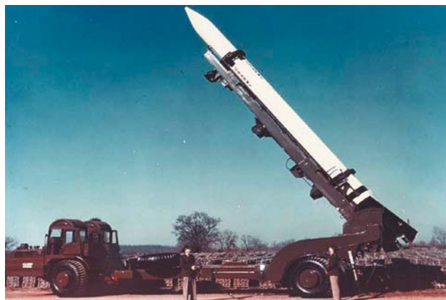
Управляемая ракета MGM-5A «Корпорал». Ракета снабжена головной ядерной частью W-7
