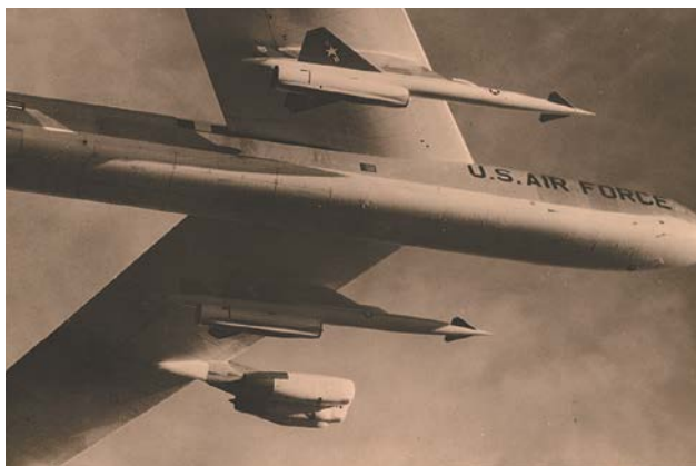
Стратегические ракеты «Хаунд Дог» под крылом бомбардировщика Б-52. Ракеты имели термоядерные боевые части W-27 или W-28
