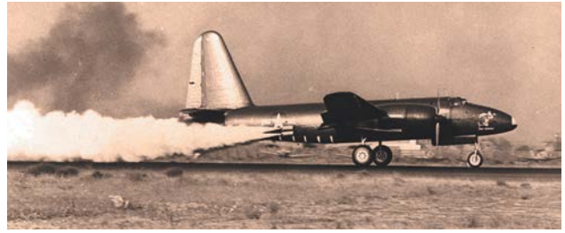
Наземная отработка взлёта бомбардировщика P2V-3C «Нептун» с помощью стартовых ускорителей
