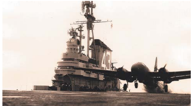
Взлёт бомбардировщика P2V-3C «Нептун» с помощью стартовых ускорителей с палубы авианосца «Коралл Си». 1951 год
