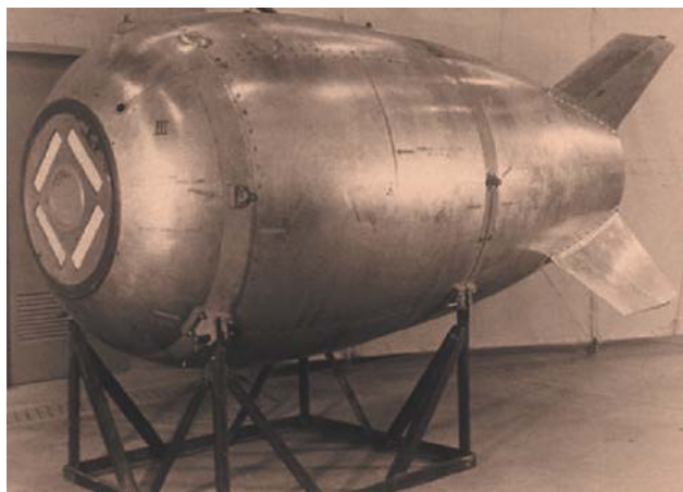
Атомная бомба Mk-4. Антенны высотомеров были перенесены в носовой торец корпуса
