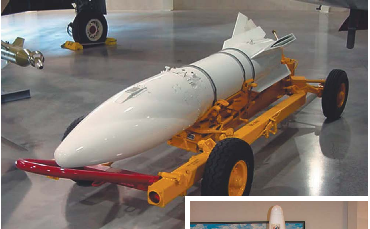
Неуправляемая ракета для поражения воздушных целей AIR-2A «Джинни-2». Обратите внимание на надкалиберную боевую часть, в которой находился атомный заряд и выдвижные перья стабилизатора
