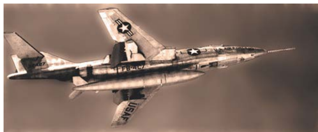
Истребитель F-101A несёт экспериментальный контейнер с топливом (2664 л) и ядерную бомбу, позволяет увеличить боевой радиус так, чтобы сопровождать тяжёлые бомбардировщики. Этот истребитель № 53-2427 с экспериментальным контейнером имеет взлётный вес почти 22,65 т (Макдоннелл Дуглас, от Тэйлора)
