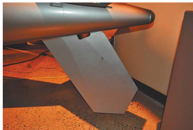
Убираемое перо стабилизатора бомбы Mk-7
