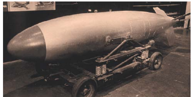
Макет бомбы МК-7 на транспортировочной тележке, в музейной экспозиции. Обратите внимание на пружинные амортизаторы ложеамента под бомбой
