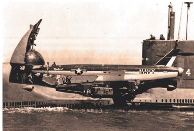
Установка ракеты «Регулус 2» на пусковую установку подводной лодки «Грэйбэк»
