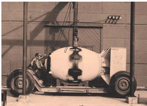
Бомба «Толстяк» в процессе подготовки к боевому применению. Швы на корпусе покрыты герметиком. На стабилизаторе, если присмотреться, видны надписи, оставленные персоналом
