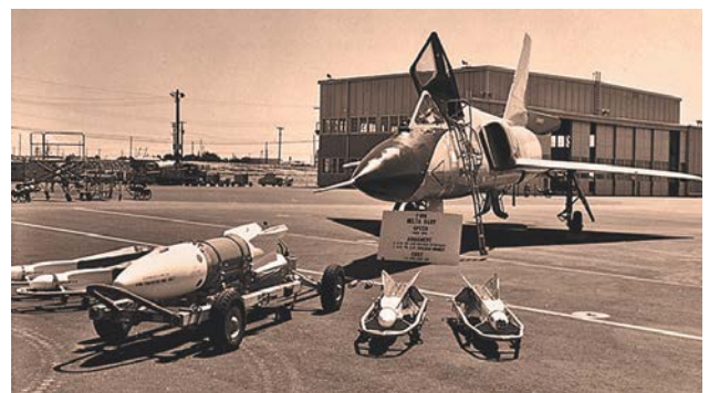
Перехватчик F-106A с комплектом ракетного вооружения, состоящего двух ракет GAR-3A, двух GAR-4A и единственной ядерной ракеты «Джинни» (Музей USAF)
