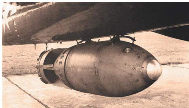
Атомная глубинная бомба Mk-90 «Бетти» на испытаниях под фюзеляжем самолёта F7F-3 «Тайгеркэт», 23 мая 1955 года
