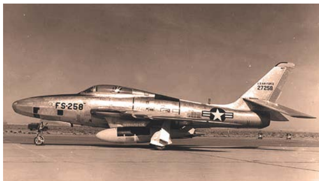
Обозначение истребителя RF-84F/RBF-84F, участвующего в программе «ФИКОН», было заменено на RF-84K в начале 1956 г. Под крылом самолёта бомба Mk-7. Отогнутые вниз плоскости стабилизатора говорят о том, что RF-84K предназначен для подвески под бомбардировщик GRB-36D
