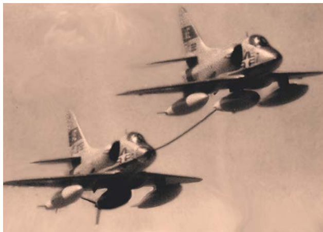
Дозаправки в воздухе штурмовика А-4Е с ядерной бомбой Т-63 (Мк-7) под фюзеляжем
