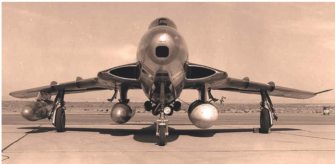
Разведчик RF-84K № 52-7258 на базе «Эдвардс». На самолёте подвешена пара топливных баков на правом крыле и «специальное оружие» Т-63 (аналог бомбы Mk-7) на левом крыле. Чтобы взлететь с тяжёлым грузом, самолёт оборудован четырьмя стартовыми ускорителями, тягой по 453 кгс, которые видны на фюзеляже
