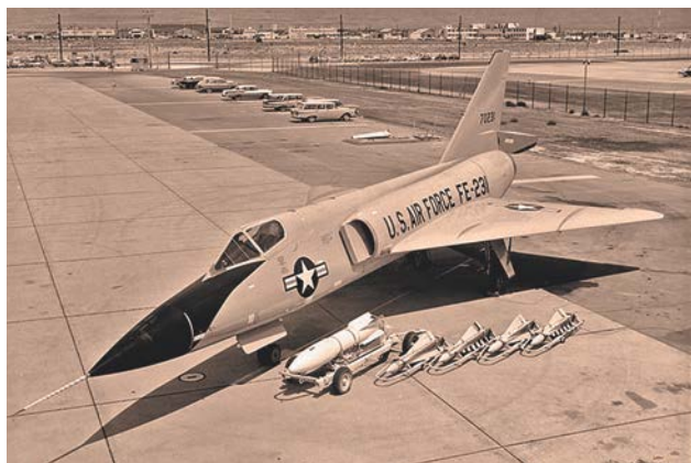
Перехватчик F-106A и его ракеты — ядерная «Джинни» и управляемые «Фалькон» GAR-3 FE
