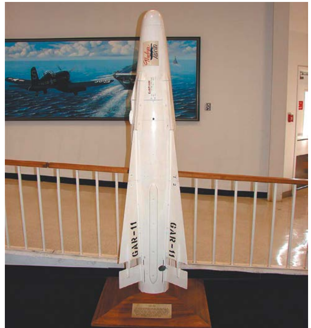
Управляемая ракета класса воздух–воздух AIM-26A (GAR-11) «Фалькон». Единственная версия, из многочисленного семейства ракет «Фалькон», снабжённая ядерной боевой частью
