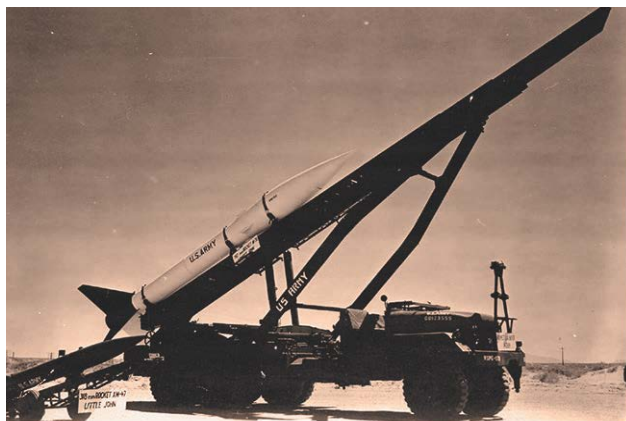
Неуправляемая ракета MGR-1A «Онест Джон» на пусковой установке М-289. Ракета снабжена головной ядерной частью W-7
