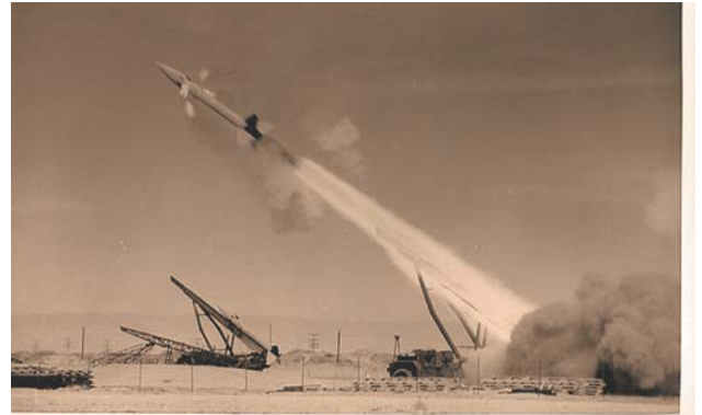
Пуск ракеты «Онест Джон». Четыре скошенных сопла производят закрутку ракеты для её дополнительной стабилизации. Факелы от их работы видны позади головной части
