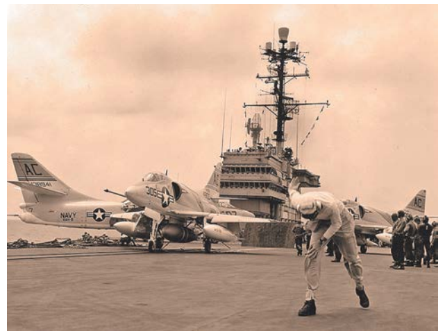
Штурмовик А-4В взлетает с палубы авианосца «Саратог». Под фюзеляжем подвешена бомба Mk-7
