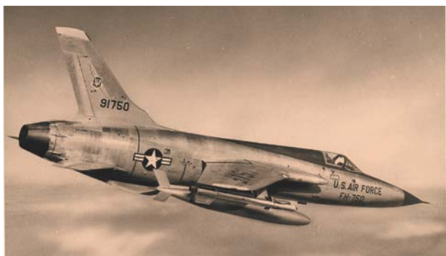
Истребитель-бомбардировщик F-105D. Под крылом виден 1705-литровый топливный бак с характерным хвостовым оперением, выполненный в корпусе не принятой на вооружение сверхзвуковой модификации атомной бомбы Mk-7
