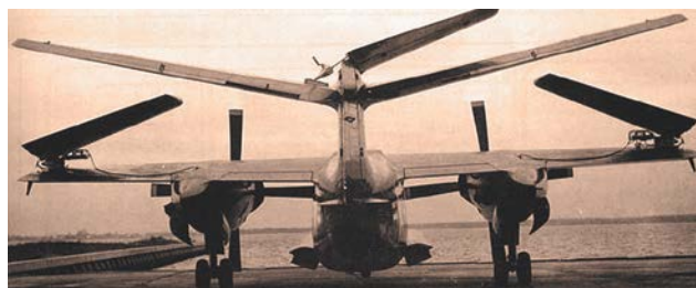
Большие размеры самолёта AJ-2 «Сэвидж», потребовали создания сложной системы его складывания
