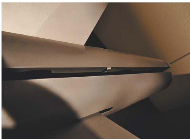
Паз для убираемого пера стабилизатора бомбы Mk-7
