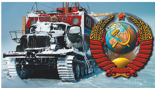
«Харьковчанка-2». От чистой АТТ её отличает удлинённая рама, более широкие гусеницы и вместо кузова стандартный жилой балок. В остальном эта труженица неотличима от прототипа
