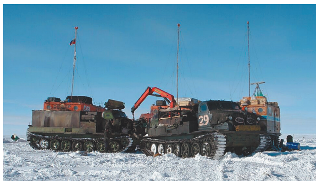
Ремонт во время похода — замена двигателя. АТТ. Техпомощь в походе редкий день без работы
