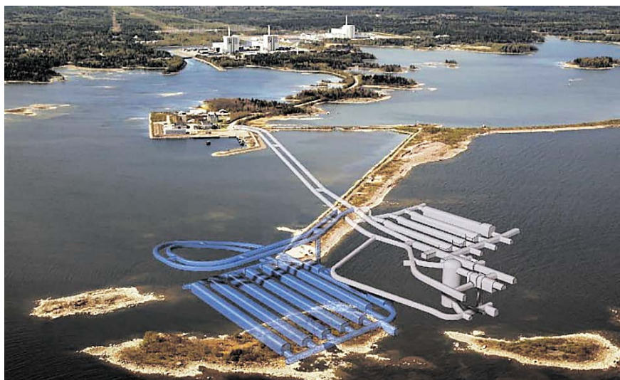
Рис. 18. Совмещённая схема расположения действующего (белого) и перспективного (синего) хранилищ SFR. https://www.world-nuclear-news.org/Articles/Swedish-regulator-supports-repository-expansion
