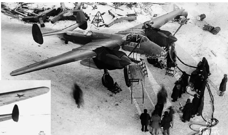
При запуске в серию под маркой Ту-2 на самолёте «103» пришлось поменять моторы и размещение вооружения, его лётные данные как пикировщика упали
