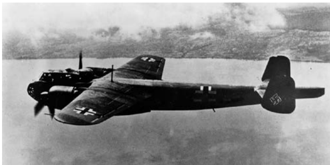
На многих дальних бомбардировщиках Дорнье Do 217E были установлены воздушные тормоза на хвостовой части, но лётчики пикировать и пользоваться ими просто побаивались
