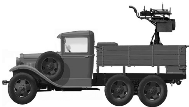
Автомобиль ГАЗ-АА с 76,2-мм установкой М4. (Рис. А. Шепса)
