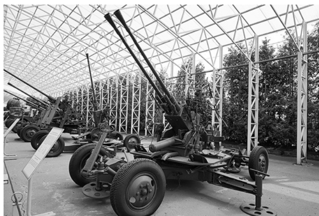
37-мм спаренная автоматическая зенитная пушка В-47 обр. 1944 г. в Музее Победы на Поклонной горе. (Фото А. Широкограда)
