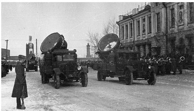
Зенитные прожекторные установки на автомобилях ГАЗ-А
