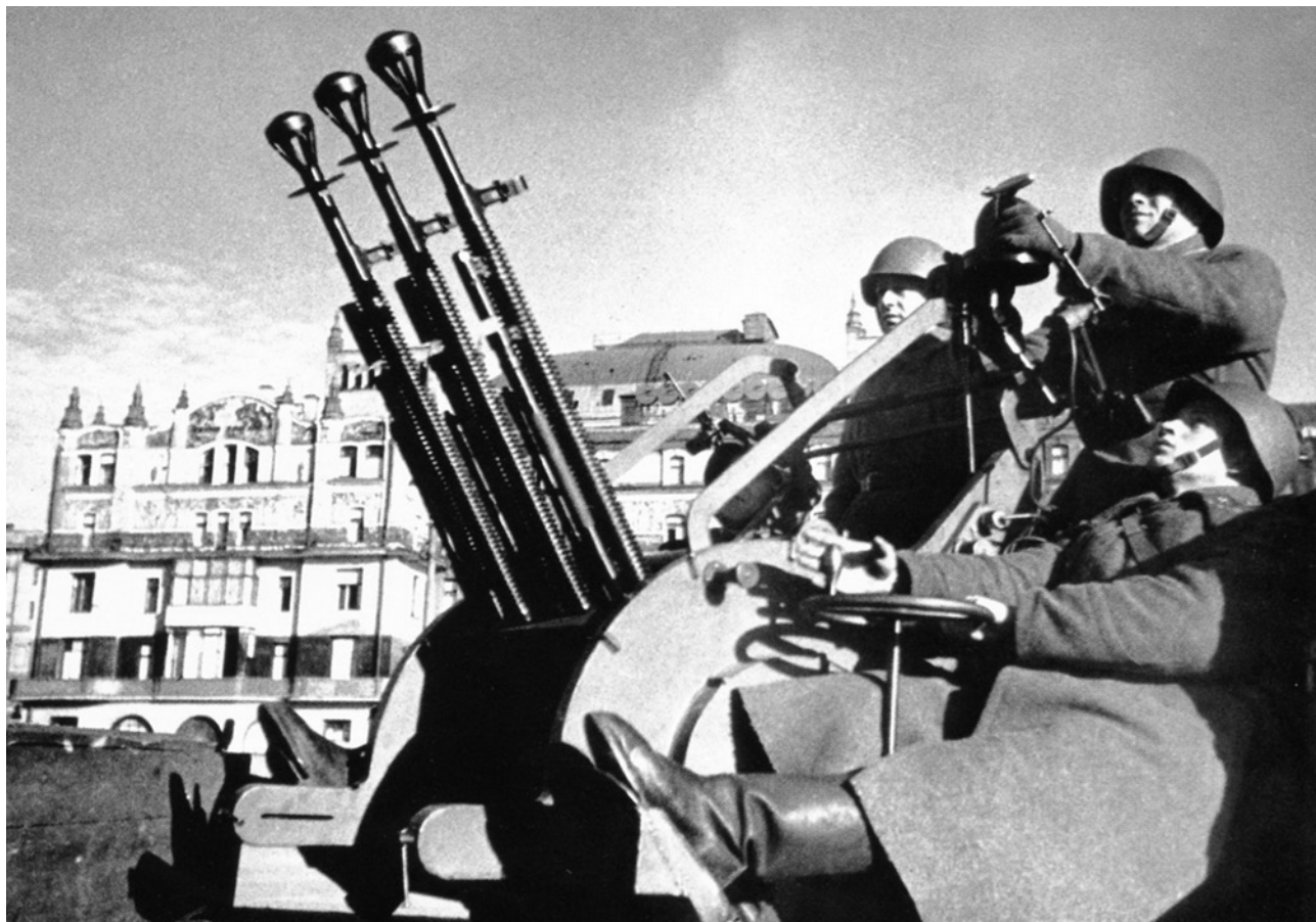
Зенитная установка (три 12,7-мм пулемета ДШК) в центре Москвы, на площади Свердлова (ныне Театральная). На заднем плане видна гостиница «Метрополь»
