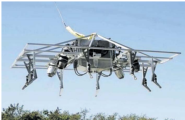
Опытный образец P1 с алюминиевой рамой завершил лётные испытания
