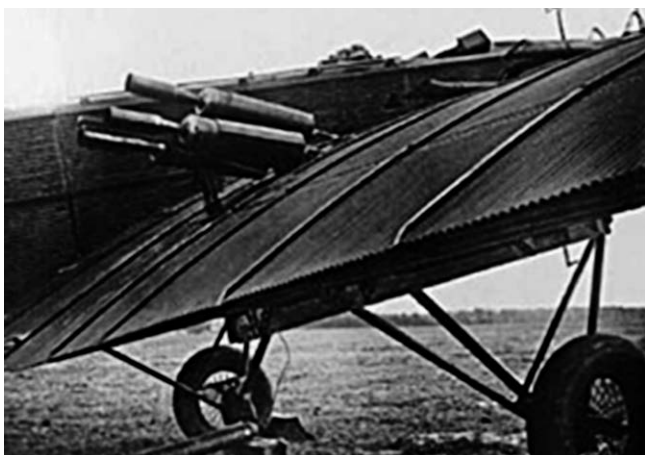
Установка стартовых ускорителей на несущие плоскости уменьшала время разбега самолёта
