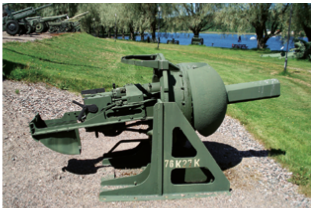
Капонирное орудие 76К, устанавливаемое на линии Молотова
