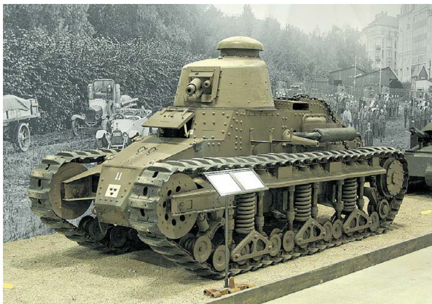
NC-1 получил совершенно новую свечную подвеску
