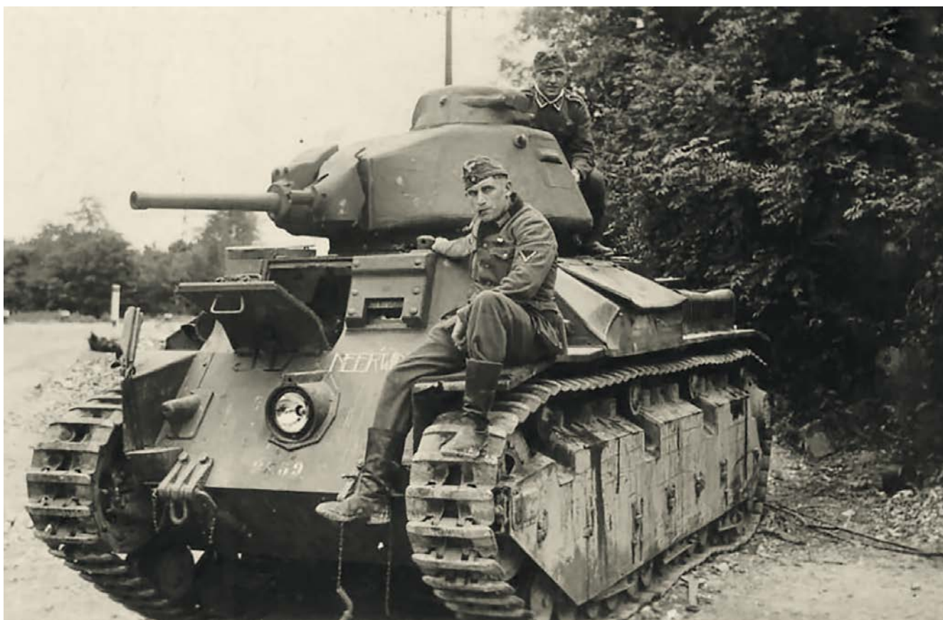
Танк D2 из второй производственной партии с длинноствольной пушкой SA-35, захваченный немцами
