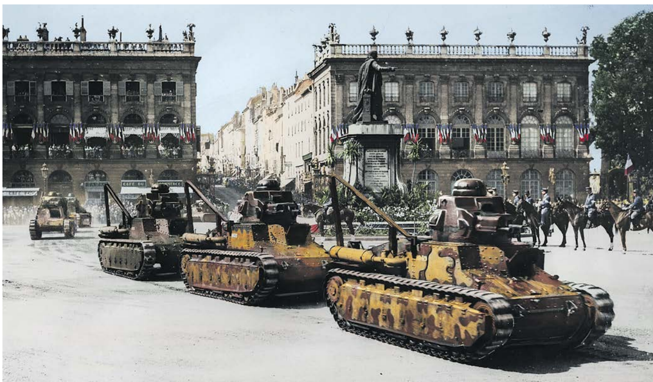
Танки D1 с башнями ST2 и 47-мм пушкой, на параде в Нанси, 1935 год. На задней части корпуса танков хорошо видны двухбалочные радиоантенны L-образной формы
