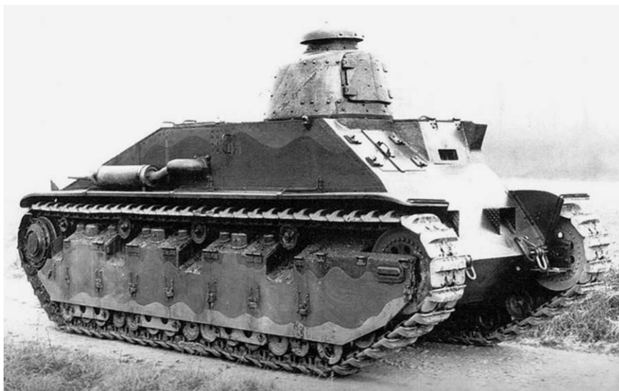
Прототип танка D2 со сварным корпусом и башней от «Рено FT»
