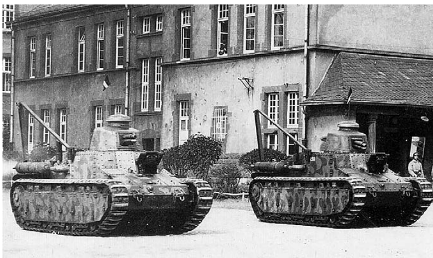
Танки D1 с башнями от старых «Рено FT» с 37-мм пушкой, 1935 год
