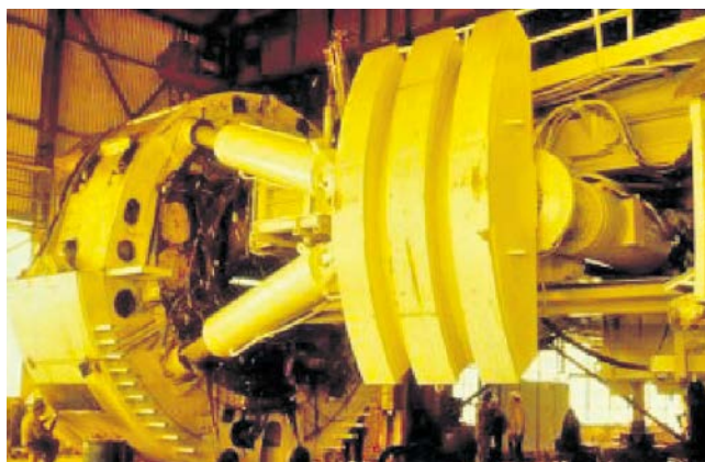
Рис. 5. Распорные домкраты буровой туннельной машины проекта TARP
