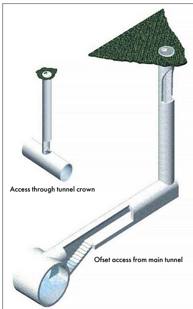
Рис. 12. Сопряжения стволов доступа с горизонтальным туннелем http://cdn.wspgroup.com/8kzmue/drop-structure-design-for-wastewater-and-stormwater-collection-systems.pdf access through tunnel crown — доступ через кровлю туннеля, offset access from main tunnel — доступ через боковую сбойку от главного туннеля
