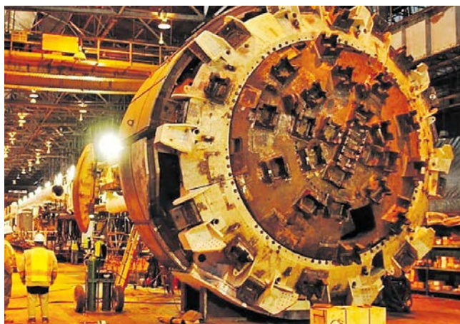
Рис. 24. Буровая туннельная машина, применявшаяся в Глубоком туннеле https://www.mmsd.com/what-we-do/wastewater-treatment/deep-tunnel
