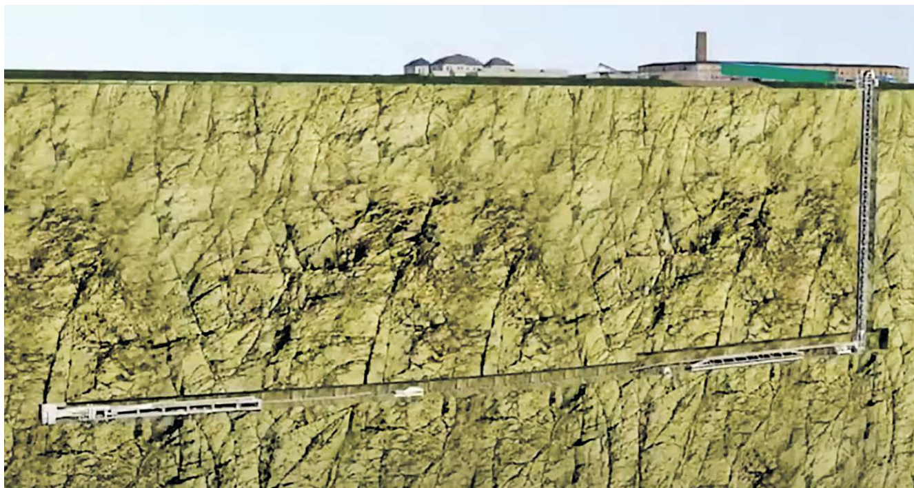
Рис. 8. Схема конвейрного транспорта породы (в том числе, по вертикальному стволу доступа), отбитой буровой туннельной машиной
