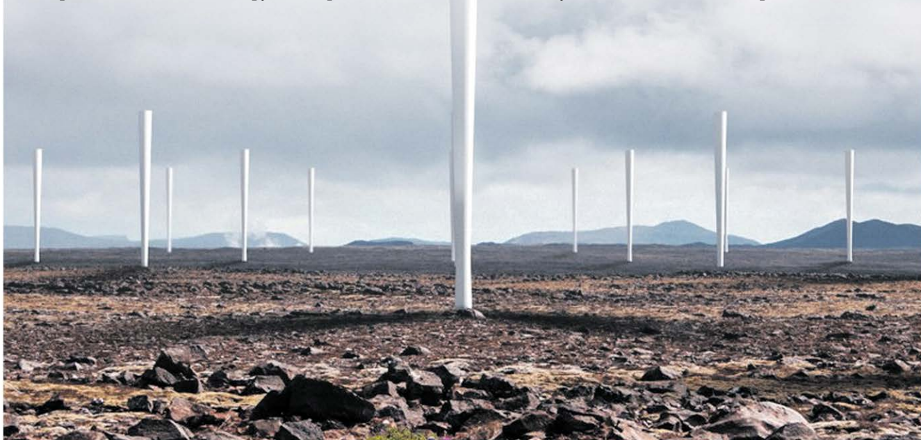
Безлопастные генераторы превращают в электричество созданную ветром кинетическую энергию вибрации
