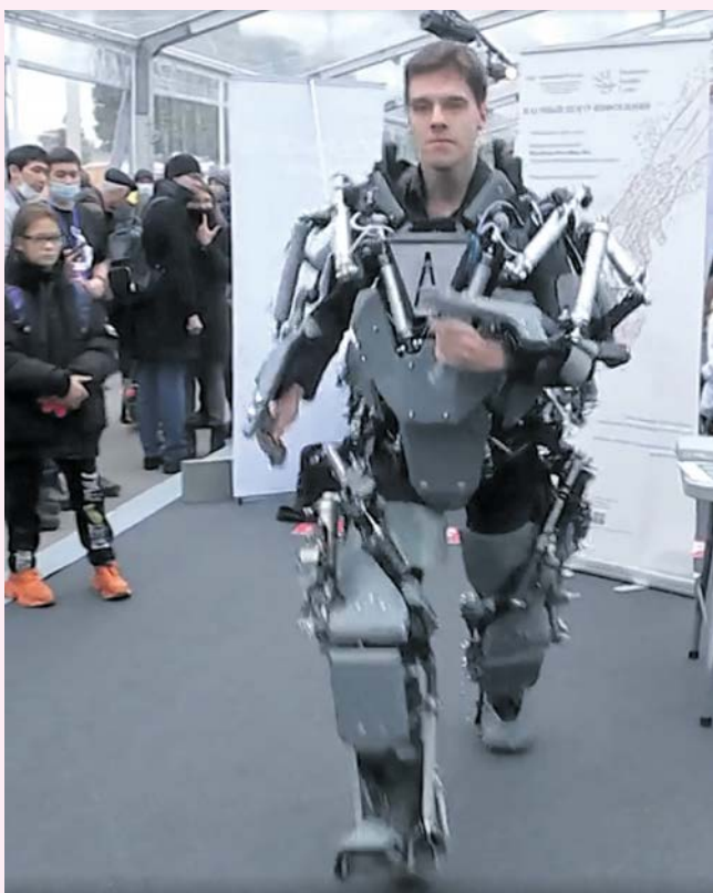
Человек в экзоскелете с пневмоприводом может не напрягаясь поднимать и переносить до 80 кг груза
