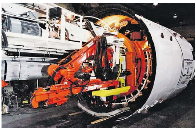
Рис. 21. Укладчики сегментной крепи https://www.tunneltalk.com/Detroit-outfall-Nov01-Set-up-for-Detroits-outfall-2.php
