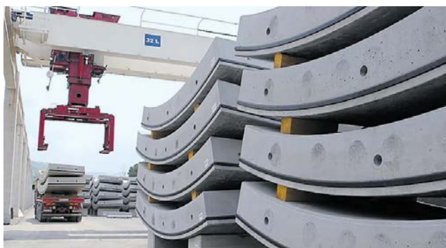
Рис. 20. Сегменты крепи, подготовленные для спуска в туннель https://www.tunneltalk.com/TunnelTECH-Oct2018-Tracking-for-segment-production.php
