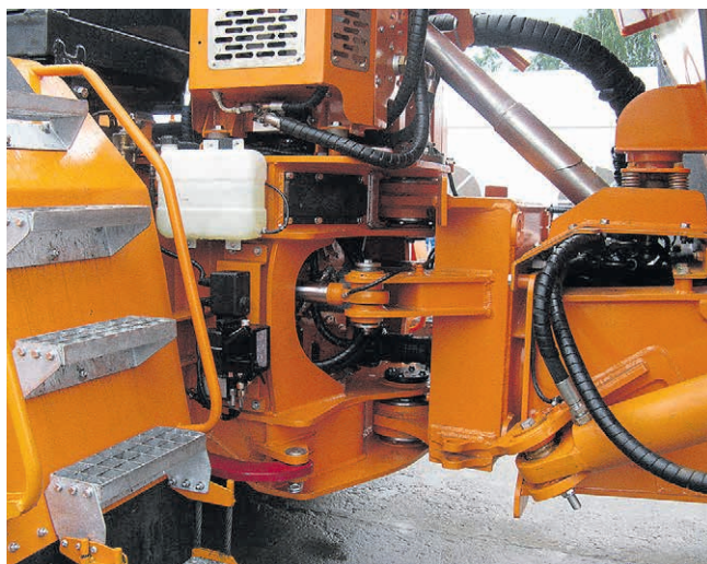
Центральный шарнир, видны рулевые гидроцилиндры
