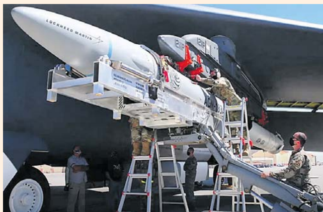
Наземный персонал авиабазы Эдвардс ведёт работы по подвеске УР AGM-183A ARRW на подкрыльевой пилон бомбардировщика B-52 H
