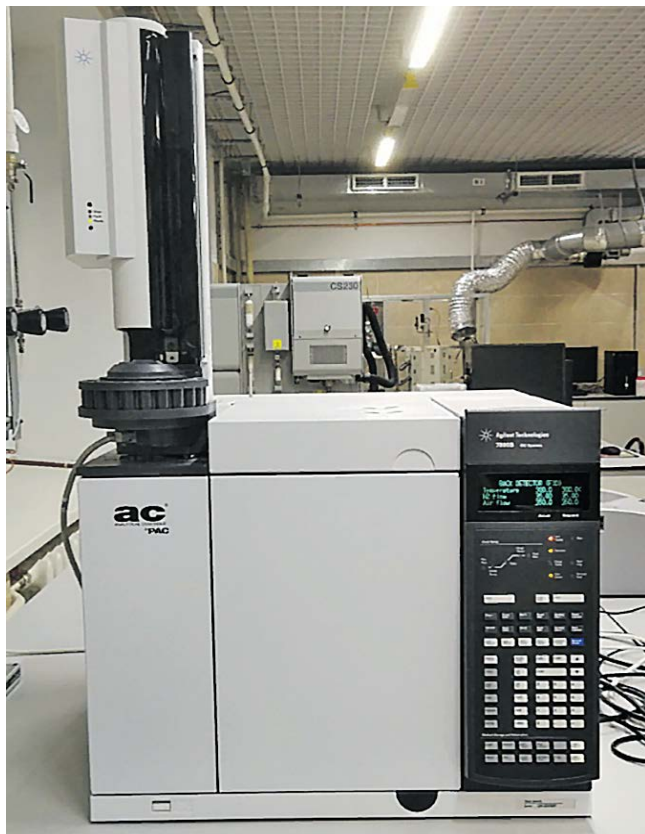
Agilent 7890B — газовый хроматограф для определения углеводородного состава бензиновых фракций
