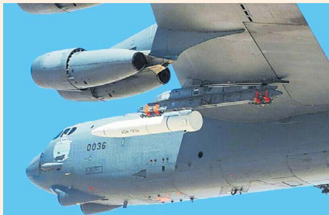
Бомбардировщик B-52H 419-й лётно-испытательной эскадрильи с ракетой AGM-183A ARRW на пилоне во время тестового полёта на «слётанность» летом 2020 года
