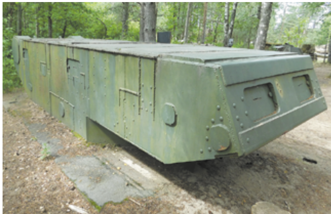
Рис. 44 Корпус танка Т-28, использованный в качестве ДОТа. Музей «Сестрорецкий рубеж». (Фото А. Широкограда)
