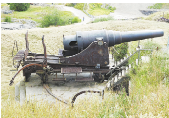
Рис. 84 11-дм чугунная пушка СА обр. 1877 г., выпущенная Пермским заводом в 1879 г. Вид сверху. (Фото А. Широкограда)
