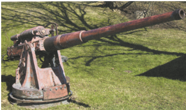
Рис. 87 75/50-мм пушка Кане с перевернутыми противооткатными устройствами. (Из книги: Ove Enqvist. Suomen Rannikkotykit. Moreeni, 2013)
