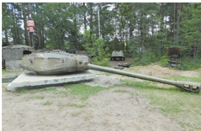
Рис. 14 Башня танка ИС-2, снятая с ДОТа. (Фото А. Широкограда)
