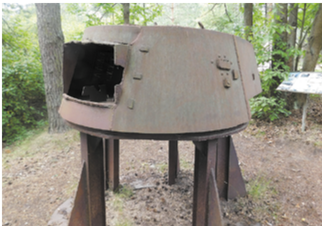
Рис. 33 Башня БТ-7, использовавшаяся в ДОТе. Вид спереди. (Фото А. Широкограда)
