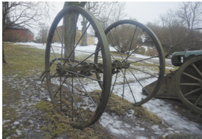
Рис. 83 Тележка для перевозки стволов орудий внутри крепости. (Фото А. Широкограда)
