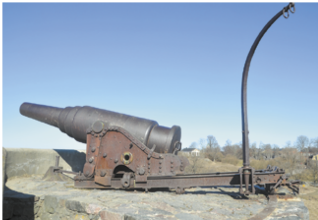
Рис. 82 11-дюймовая стальная пушка обр. 1867 г., изготовленная в 1876 г. на Пермском заводе. Вид сбоку. (Фото А. Широкограда)
