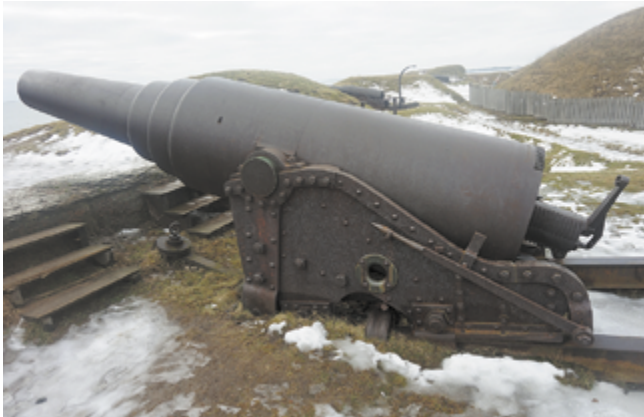
Рис. 103 9-дм пушка обр. 1867 г. Пермского завода с поршневым замком. (Фото А. Широкограда)
