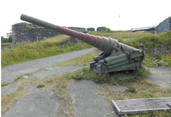
Рис. 107 152/35-мм корабельная пушка на бортовом станке Дурляхера, изготовленная Обуховским заводом в 1889 г. (Фото А. Широкограда)
