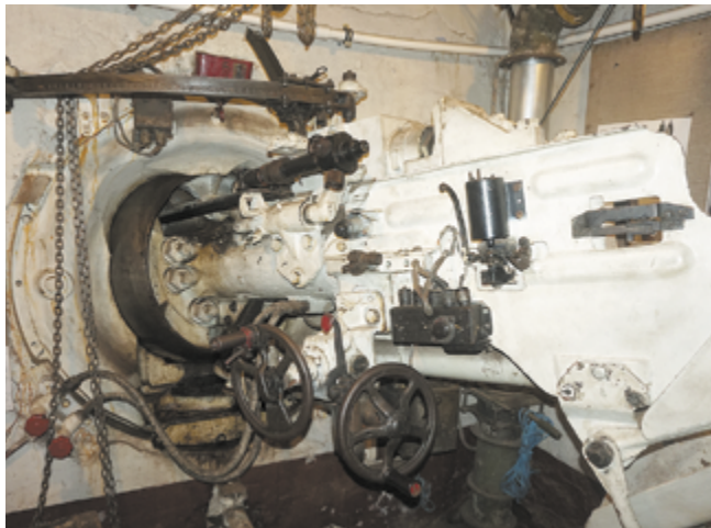
Рис. 28 85-мм пушка ЗИФ-26. Их устанавливали в казематы 76-мм пушек Л-17. (Фото А. Широкограда)
