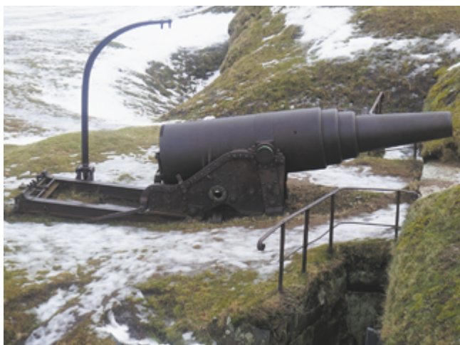
Рис. 63 9-дм пушка обр. 1867 г. с поршневым затвором, изготовленная Пермским заводом в 1873 г. (Фото А. Широкограда)
