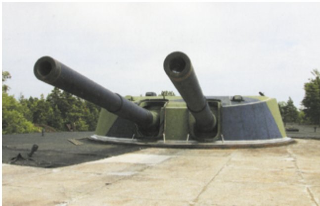
Рис. 93 305/52-мм двухорудийная башенная установка на о. Мякилуото. (Из книги: Ove Enqvist. Suomen Rannikkotykit. Moreeni, 2013)
