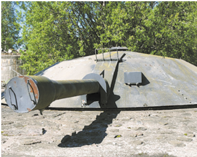
Рис. 113 Финская башенная модификация 6-дм (152-мм) установки Кане. Вид снаружи
