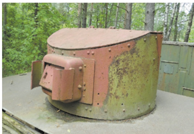
Рис. 39 Танковая огневая точка на базе танка БТ-2. (Фото А. Широкограда)
