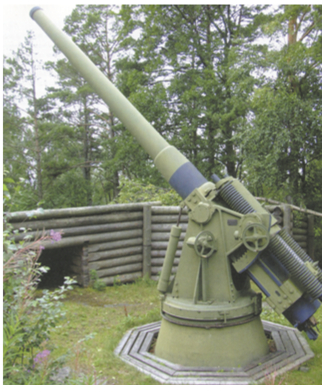
Рис. 96 Первая модернизация финнами 152/45-мм пушки Кане. Как видим, противооткатные устройства перевернуты. (Из книги: Ove Enqvist. Suomen Rannikkotykit. Moreeni, 2013)
