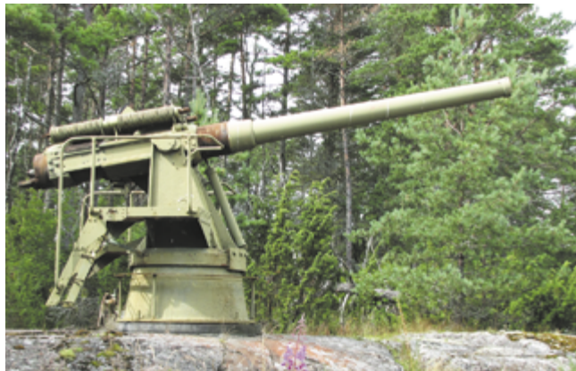
Рис. 94 120/45-мм пушка Кане, модернизированная финнами. Противооткатные устройства перевернуты
