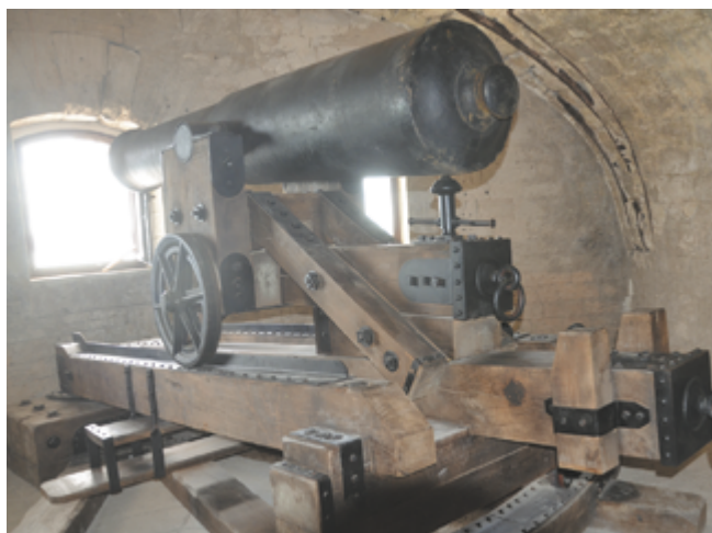
Рис. 70 1-пудовый длинный чугунный единокорог обр. 1838 г. на крепостном станке обр. 1852 г. в каземате. (Фото А. Широкограда)
