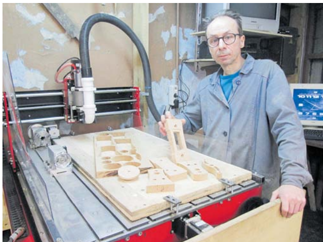
Денис Молостов у станка с ЧПУ, на котором вырезаны элементы корпуса электропрямки «Ариадна»
