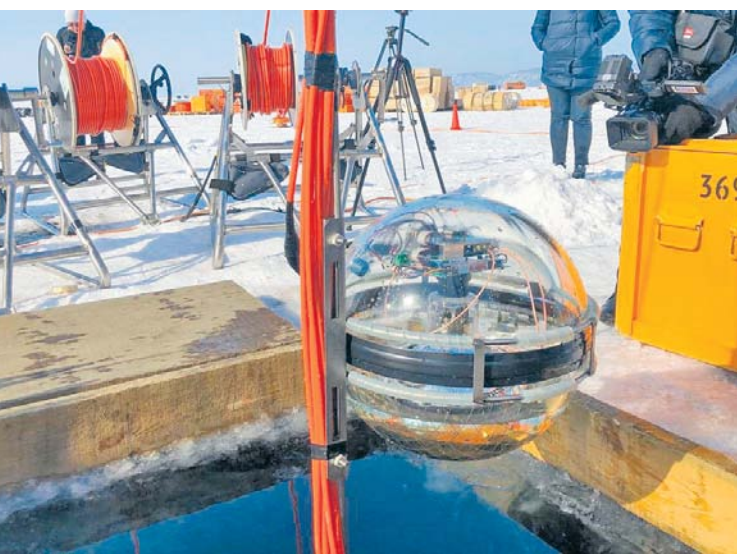
Очередную ловушку аккуратно опускают в воду вместе с кабель-тросом. Фото: ing.ru
